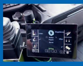
«JST» Joystick-Steuerung mit grossem Touchscreen-Monitor und optionalem automatischen Rückraumkamera-Sicherheitspaket.
